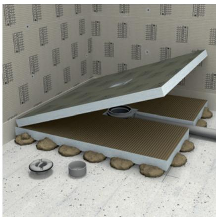
**Kleberbatzen** – Zum Ausgleichen unebener Untergründe, um das Duschbodenelement exakt waagerecht auszurichten. Abstand der Mörtelbatzen ca. 20 cm, Höhenausgleich von 0 – ca. 6 cm.
