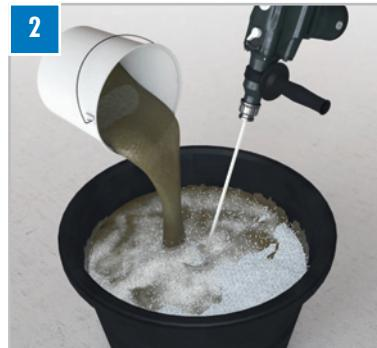
Ein Höhenausgleich mittels TUB-U S 90 ist bei der Duschbodenmontage vor allem dann sinnvoll, wenn die Verwendung der in solchen Fällen sonst üblichen Unterbauelemente TUB-U... nicht möglich ist – also z.B., wenn unterhalb des geplanten Duschplatzes zusätzliche Leitungen verlaufen oder als Höhenausgleich bei starken Unebenheiten des Untergrundes.
